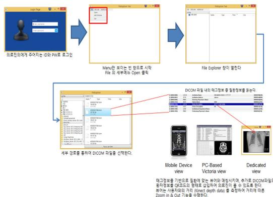
(그림 10) 키워드 매칭에 의한 뷰어 매칭 시스템의 구현
