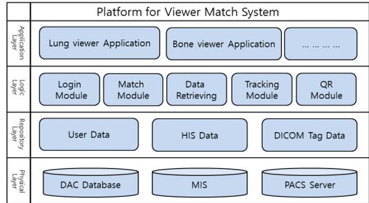
(그림 2) 의료영상 뷰어 매칭 시스템의 플랫폼 구조
