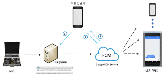
(그림 8) 인증문자 전송 구조 및 응급 메시지 알림 (Figure 8) Authentication Character Transmission Structure and Notification of Emergency Message Notification
