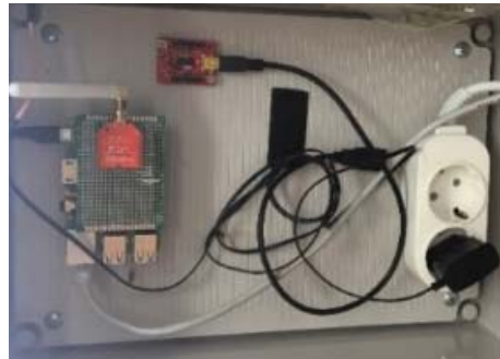
(그림 4) 로라 게이트웨이 노드의 프로토타입 (Figure 4) A LoRa gateway prototype
