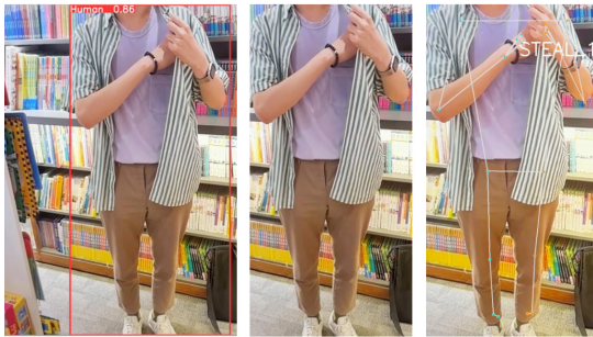
(그림 4) 객체인식과 모션캡처를 이용한 움직임 탐지 (Figure 4) Moving behavior detection fusing object recognitions and motion captures
