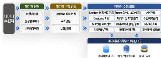
(그림 4) 무기체계 CBM+ 시스템의 데이터 수집·연동 모듈 (Figure 4) Sensor Data Collection Module of Weapon System CBM+ System
