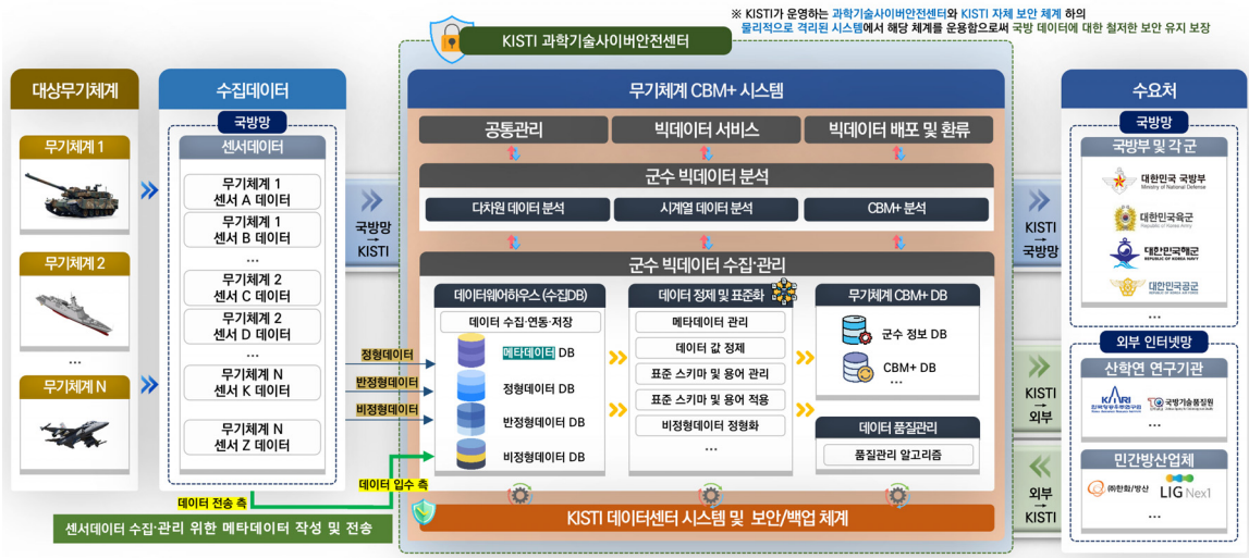
(그림 3) 무기체계 CBM+ 시스템 구성도 (Figure 3) The CBM+ System Architecture for Weapon System
