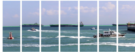
(그림 4) 이미지 분할을 통한 수평선 검출 (Figure 4) Horizontal line detection with image segmentation
