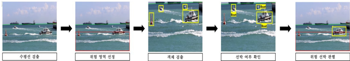
(그림 1) 해상 객체 검출 순서도 (Figure 1) maritime object detection flow chart
