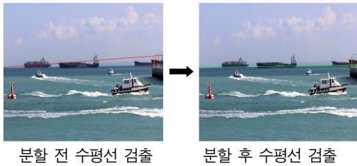
(그림 5) 이미지 분할 전, 후 수평선 검출 결과 비교 (Figure 5) Compare horizontal line detection before and after image segmentation
